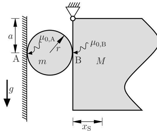
Für das System zeigt sich, dass die Normalkräfte und die Beträge der Haftkräfte beider Kontaktstellen jeweils übereinstimmen  $|H| := |H_A| = |H_B|$ ,  $N := N_A = N_B$ .
