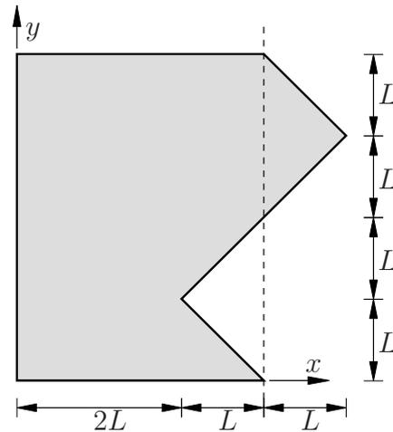
Zunächst sollen die Schwerpunktskoordinate  $x_S$  sowie die Fläche  $A$  des Körpers bezogen auf das globale  $x$ - $y$ -Koordinatensystem berechnet werden.
