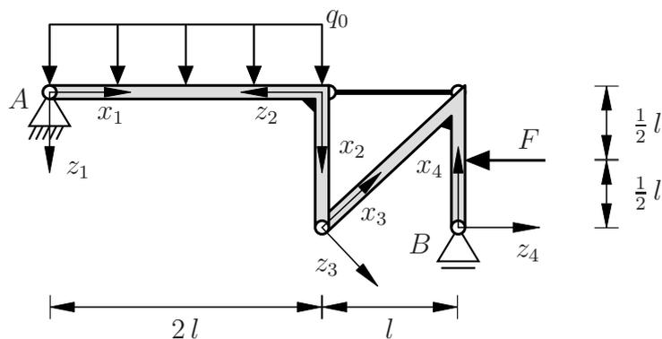
Es gelte  $F = 3 q_0 l$ . Für diesen Fall wurden die Lagerreaktionen (in positive Koordinatenrichtungen) in  $A$  und  $B$  bereits bestimmt zu
